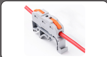
Длина зачистки проводника 10–11 мм
